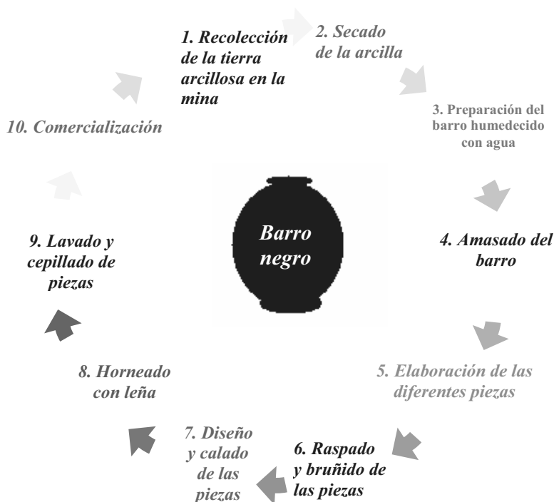
Figura 5. Proceso de producción del barro negro
