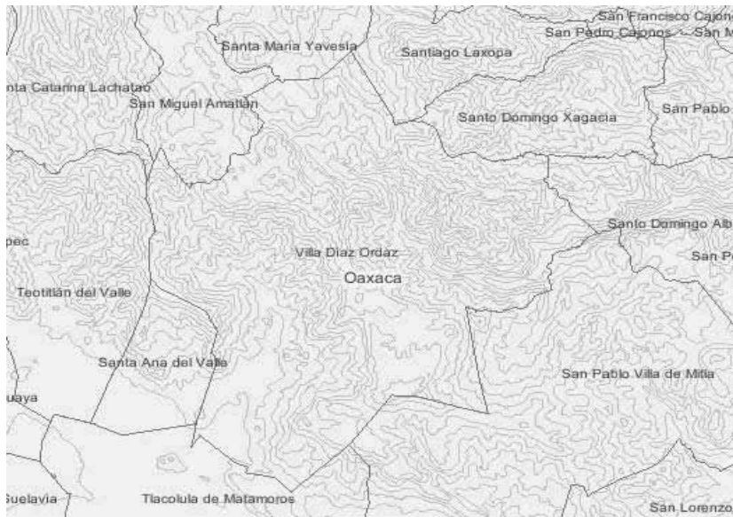
IMAGEN 6. Curvas a nivel, entre cada línea curveada hay una diferencia de 20 m. de altura. FUENTE. Mapas digitales de México INEGI.
