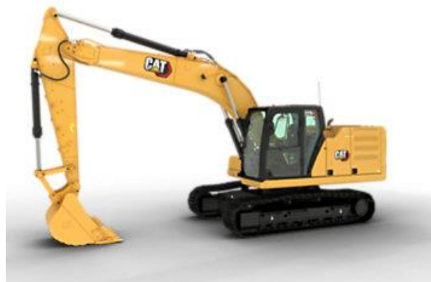
Figura 54.- EXCAVADORA DE ORUGAS 320 GC
